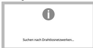
2. Wählen Sie das gewünschte Netzwerk aus und geben Sie den Netzwerkschlüssel ein. Mit der Option „Erweitert“ kann der Benutzer bei Bedarf die erweiterten Netzwerkdetails hinzufügen/bearbeiten. Die drahtlosen Sicherheitsmaßnahmen werden von der lokalen IT-Infrastruktur bestimmt. Die verfügbaren Optionen für das Alpha sind „Keine“ (offenes Netzwerk), WPA-PSK, WPA-EAP und IEEE8021X.
